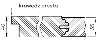
Przekrój poziomy drzwi Nestor
