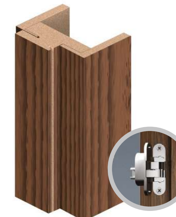
Bezprzylgowa ościeżnica regulowana VERA z zawiasem chowanym (zlicowana ze skrzydłem)
