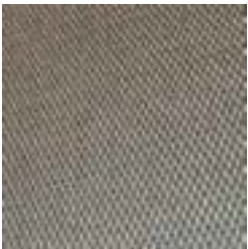
unikalna powierzchnia CPL 0,15 ze strukturą tkaniny lnianej przeplatanej metalicznym blaskiem
