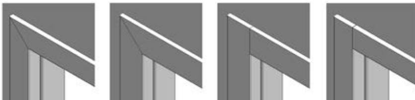
wersja A kąt łączenia 45° szerokość 60 mm bez dopłaty
